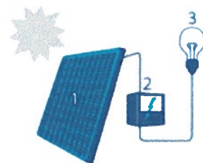
1. Zonnepaneel | 2. Omvormer | 3. Elektrische toestellen
